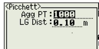
Dopo aver registrato il punto, il display torna alla schermata di osservazione. Quando si preme **[ESC]**, il display torna alla schermata di inserimento PT/CD/R. Se si inserisce il punto di picchettamento utilizzando un nome di punto singolo, il PT assume come predefinito l'ultimo PT + 1.
