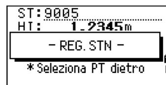
**NOTA** – I dati minimi richiesti per una resezione sono tre misurazioni angolari o una misurazione angolare e una misurazione di distanza. Se si utilizza una misurazione di distanza, la distanza tra i punti di mira deve essere maggiore della distanza misurata.
