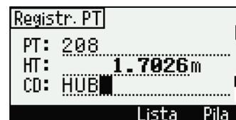
Si può anche usare l'elenco di codici o la pila di codici. Per ulteriori
