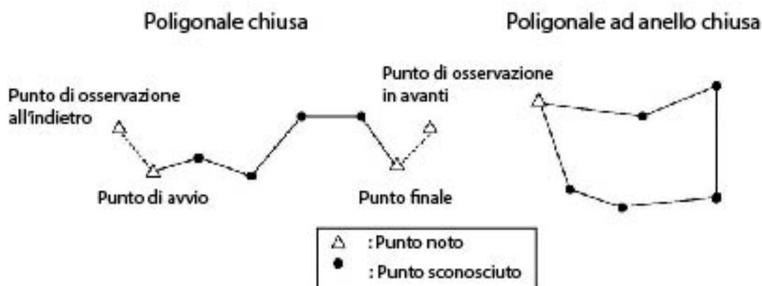
Le coordinate del punto di misurazione sono calcolate anche da punti sconosciuti come P1, P2 e P3 mostrati nella figura sotto.
