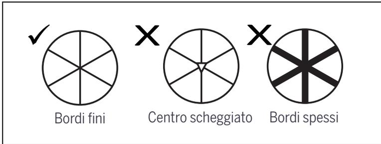
Poiché la Trimble C3 total station è estremamente sensibile, riflessi multipli sulla superficie del prisma possono talvolta provocare una significativa perdita di precisione.
