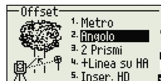
**Suggerimento** – Un offset angolare può essere registrato nella schermata di misurazione di base (BMS). Dopo aver effettuato la misurazione della distanza, ruotare l'alidada e/o il cannocchiale. Premere quindi **[ENT]** per registrare la distanza misurata con il valore dell'angolo aggiornato. Se si impiega questo metodo, la dimensione dell'offset dell'angolo non è memorizzata come record CO. Per memorizzare il record CO, usare la funzione O/S.
