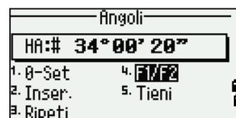
Se sono già state rilevate delle misurazioni di distanza dalla mira, è possibile inizializzare la media di F1/F2 ruotando il cannocchiale sull'altra faccia.
