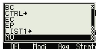
Viene visualizzata la schermata di modifica. Per i punti, viene visualizzata la schermata **Modifica voce**. Contiene solo il campo PT. Per i codici, viene visualizzata la schermata **Modifica codice**, che contiene il campo CD e il campo REC.
