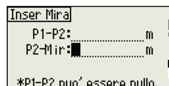
5. Se si immette una distanza P1-P2, viene visualizzata la schermata QA. Comparare il valore inserito e la distanza misurata per controllare la precisione dell'osservazione.
